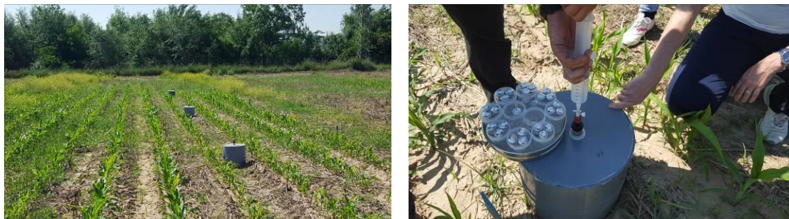
Imagen 22. Contenedores de PVC dispuestos en la finca demostrativa y proceso de extracción del gas.
