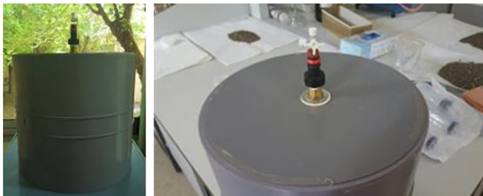
Imagen 21. Detalle de las cámaras de captura del gas \text{N}_2\text{O} .
