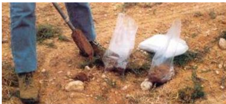
Imagen 19. Toma de muestras de suelo con barrena Veihmeyer.
